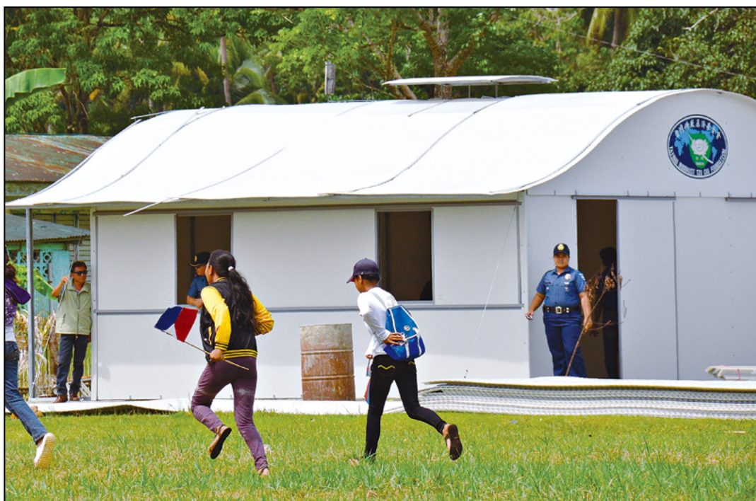
上图：第一代简易教室采半圆型造型，每间七十八平方米，可容纳七十二位学生。（摄影／萧耀华 地点●三宝颜） 下图：第二代简易教室约三十四平方米，人字屋型，四面墙直立，更能让角落充分利用。（摄影／游锡璋 地点●保和岛）
