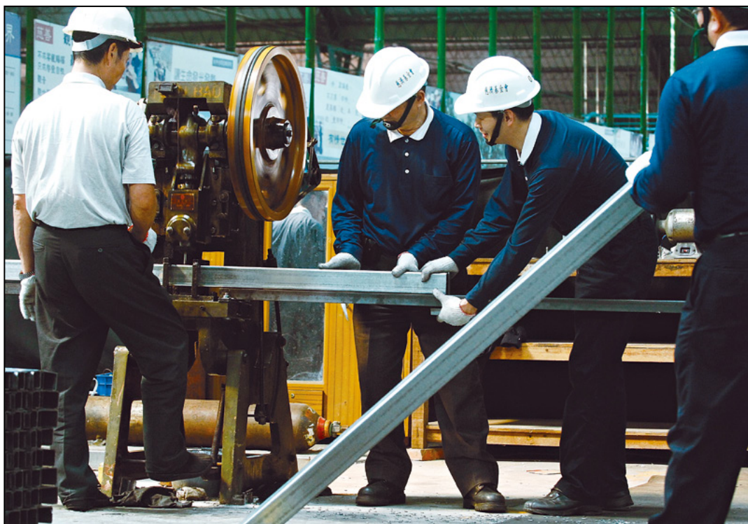
上图：螺丝孔位置是否精准，攸关组装的成败，因此志工们在操作冲孔机为骨架打螺丝孔时，莫不聚精会神。下图：S型屋顶支架，先由专业厂商以大型机具加压成型，再运到慈济园区，交给志工进行冲孔、打磨等简易加工。
